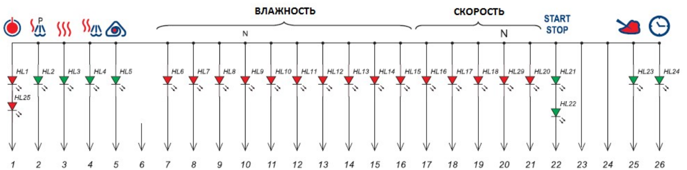
Схема электрическая соединения светодиодов
